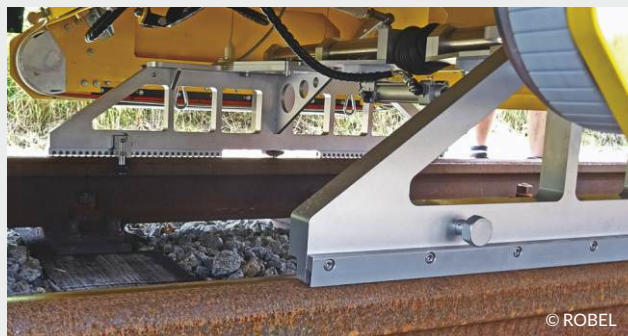
RMF 1100 integriert in Bearbeitungsmaschine
