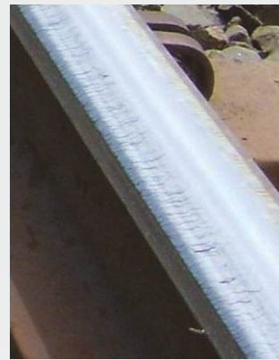
Rollkontaktermüdungen auf dem Gleis und das Abbild im Messprogramm
