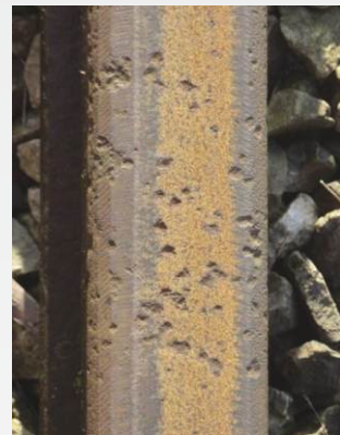
Ausbröckelungen auf dem Gleis und das Abbild im Messprogramm
