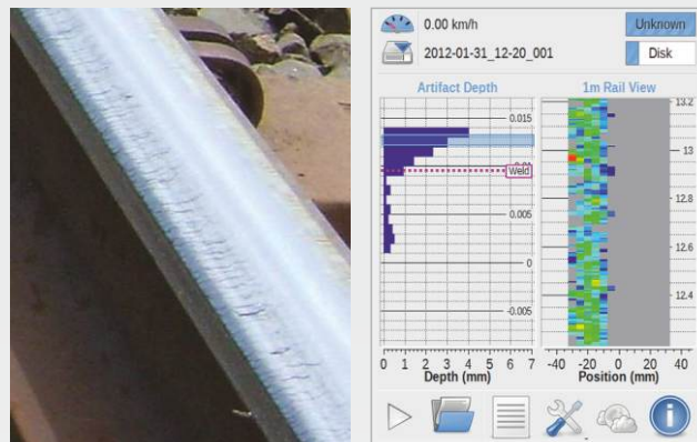
Fatigues de contact de roulement sur la voie et la représentation dans le programme de mesure
