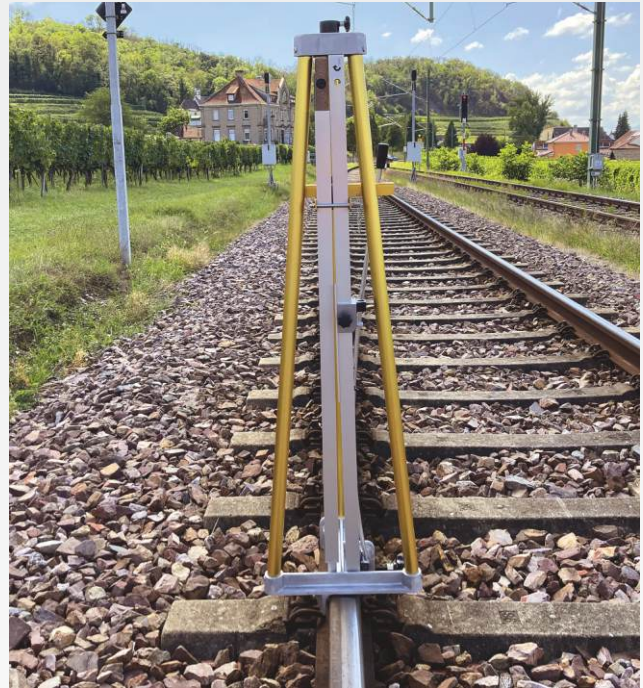
VIG 1300 avec règle de nivellement divisée et fixée
