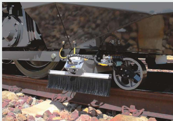
Integriertes laserbasiertes Querprofilmesssystem
