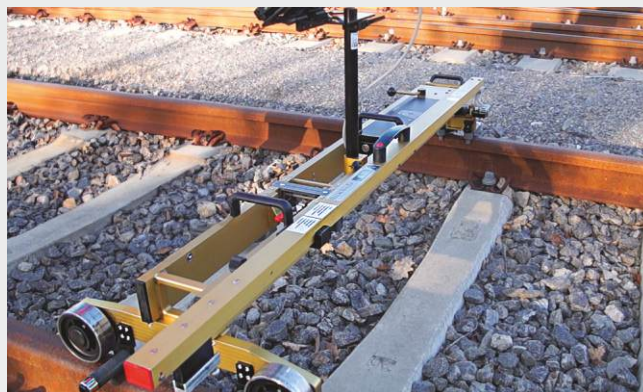
MessReg CTS II avec support pour règle de mesure d'aiguillage
