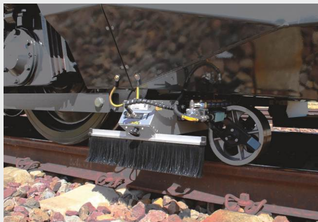
Système intégré de mesure de profil transversal par laser
